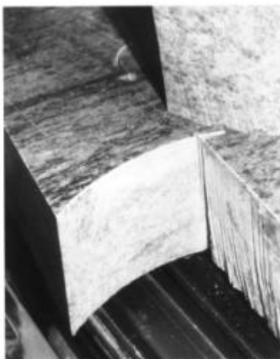
Bild 35: Vergleich von Verschleiß- und Deformationszone am Beispiel Granit links: Qualitätsschnitt, rechts: Trenn-Schnitt
